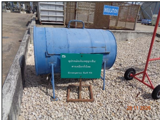
รูปที่ 3.8 ถังทรายดูดซับสารเคมี
