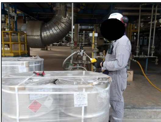
รูปที่ 3.6 การสูบน้ำยาสารเอทิลีนไดคลอไรด์
